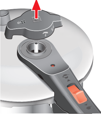
Resim 21: Basınç regülatörünün kaldırılması
