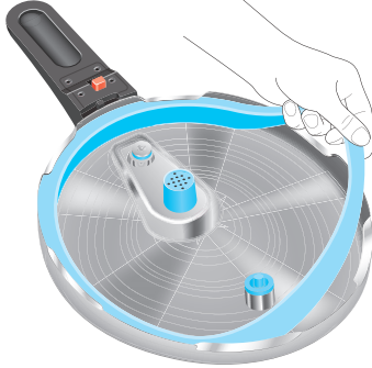
Resim 6: Conta halkasının çekilip alınması
