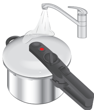
Fig. 16: Raffreddare con acqua
