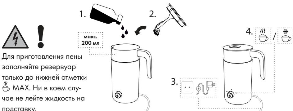
**⚠** Для приготовления пены заполняйте резервуар только до нижней отметки ☹ MAX. Ни в коем случае не лейте жидкость на подставку.
