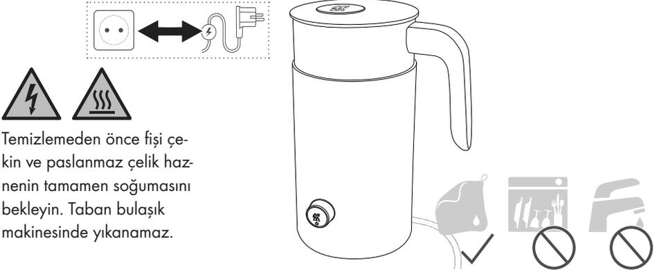
Temizlemeden önce fişi çekin ve paslanmaz çelik haznenin tamamen soğumasını bekleyin. Taban bulaşık makinesinde yıkanamaz.
