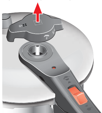
Fig. 21: Retirar el regulador de presión
