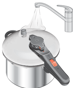
Рис. 16: Охладить водой
