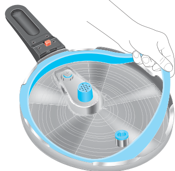
Fig. 7: Estrarre l'anello di tenuta
