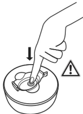
Si le récipient isolant devait être sous pression, vous pouvez dissiper la pression progressivement en appuyant sur la valve d'équilibrage de pression.
