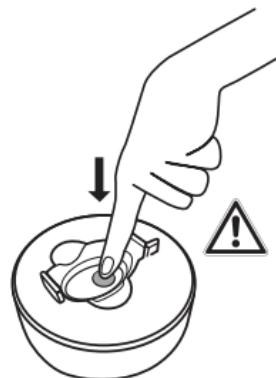
Yalıtımlı kpta basınç oluşmuşsa, basınç dengeleme valfine basarak basıncı dikkatlice tahliye edebilirsiniz.
