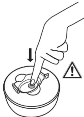
Если в изолирующей емкости образовалось давление, его можно осторожно сбросить при помощи уравнительного клапана.
