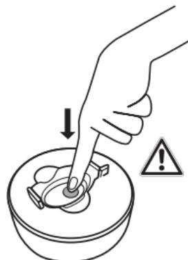
Se all'interno del portavivande termico si è instaurata una certa pressione, è possibile scaricarla con cautela premendo l'apposita valvola di compensazione.
