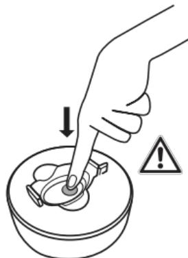
Sollte sich im Isoliergefäß Druck aufgebaut haben, können Sie diesen durch Drücken des Druckausgleichsventils vorsichtig entweichen lassen.
